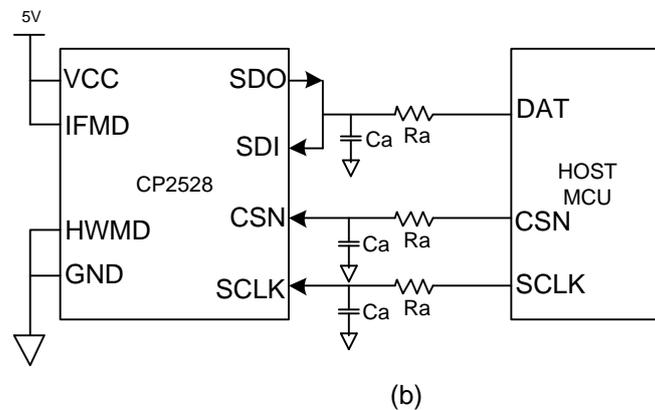
图 11 SPI 典型配置，(a) 为 4 线 SPI，(b) 为 3 线 SPI
