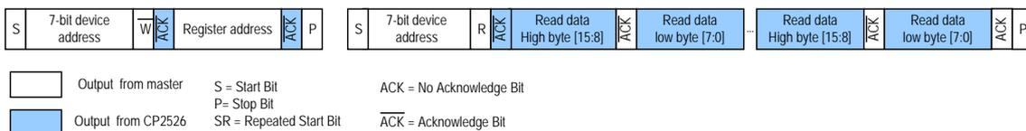
图 18 IIC 读操作
