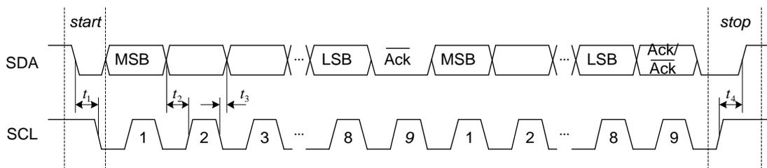
图 16 IIC 时序图
