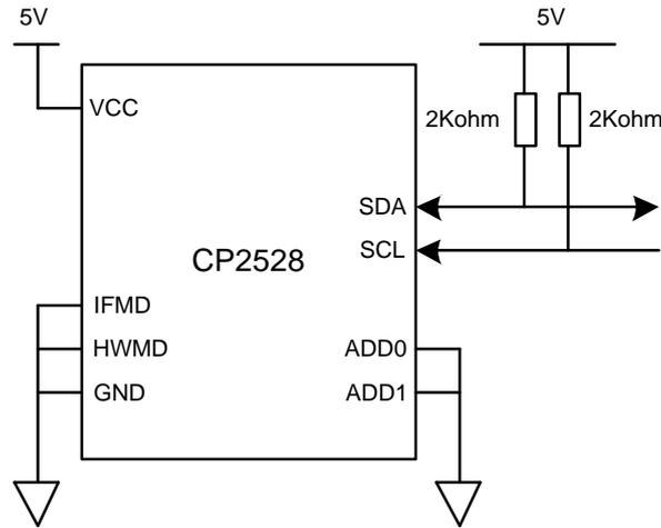
图 15 IIC 典型配置
