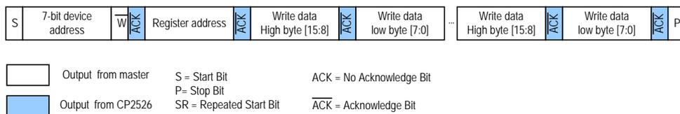
图 17 IIC 写操作
