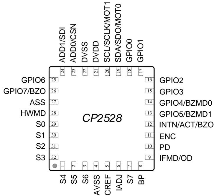
图 1 CP2528 QFN32 引脚排列图
